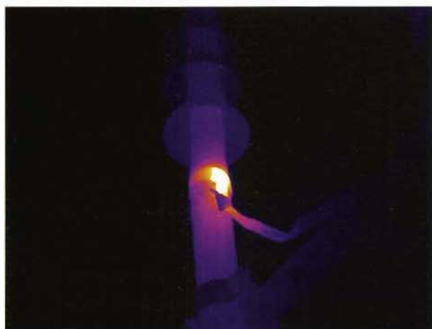
图 J. 21 电缆屏蔽层发热，电场不均匀
