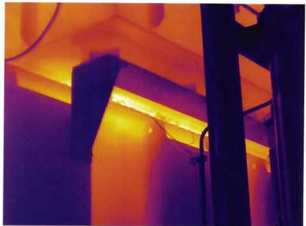
图 J.3 变压器低压侧涡流引起发热
