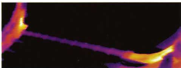
图 J. 51 电动机断股引起发热，电阻变化
